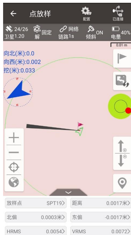
图 4.25 倾斜补偿开启时进行点放样
