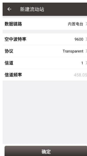
图 4.17 流动站配置-内置电台
