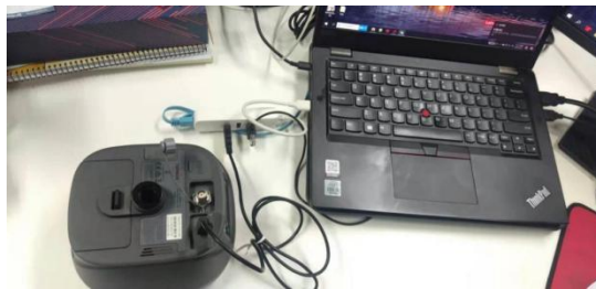
图 2.26 Mini USB 线连接奥斯卡-TAP 与电脑
